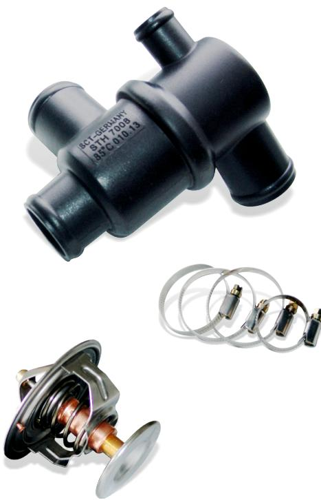
Термостат используется в системе охлаждения двигателя для управления потоком охлаждающей жидкости между двигателем и радиатором. В результате его работы обеспечивается быстрый прогрев двигателя при запуске и поддержание оптимального температурного режима на всех режимах работы. Термостат в системе охлаждения двигателя применяется с 1922 года.
