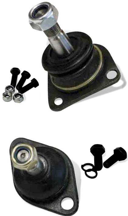
Шаровая опора - деталь автомобиля, которая является узлом соединения рычага подвески и ступицы управляемого колеса. Она позволяет поворачивать ступицу при фиксированном положении колеса в горизонтальной плоскости, во время его вертикального перемещения. Сама опора представляет собой конусообразный палец с наконечником в форме шара, который может одновременно вращаться и раскачиваться в корпусе опоры на небольшие углы.
