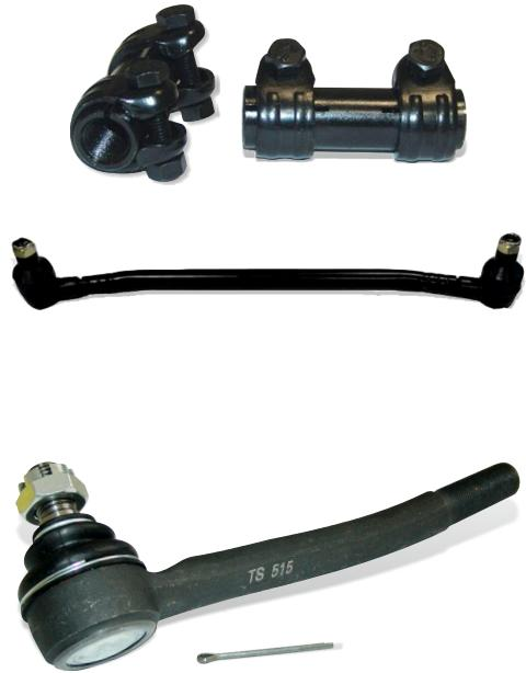
Рулевые тяги передают усилия к поворотным рычагам ступиц от рулевого механизма, с помощью которого осуществляется поворот колес. Они также есть частью рулевой трапеции, одновременно обеспечивая поворот колес на различные углы - ведь во время поворота колеса катятся по разным радиусам.
